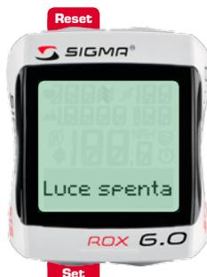
Premendo contemporaneamente i pulsanti funzione **Set** e **Reset** si attiva/disattiva la funzione di illuminazione. Sul display appare brevemente "Luce on/Luce off".
