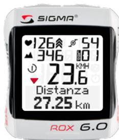
Se la velocità corrente si discosta dalla velocità media, ciò viene indicato da due frecce **◆**.
